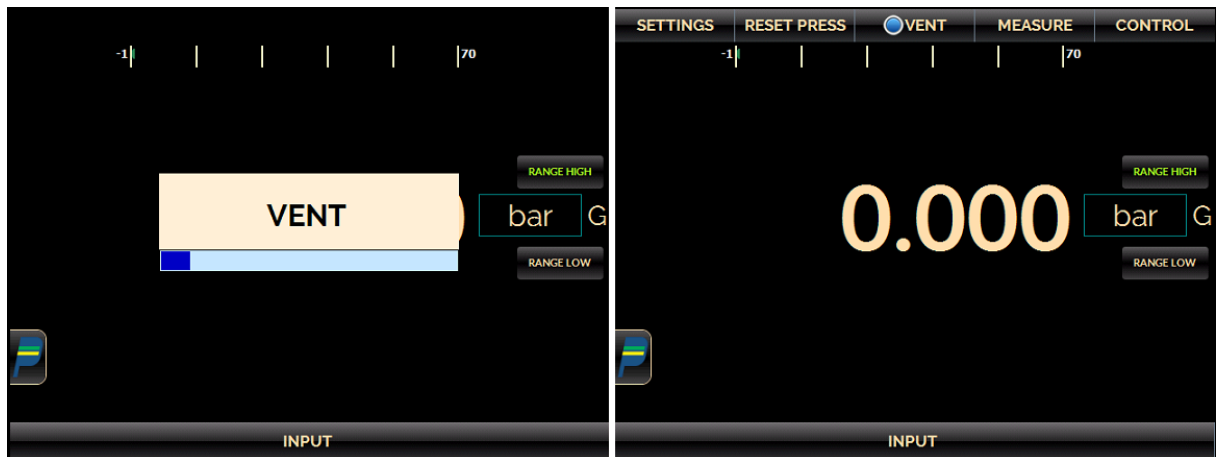
Fig. 05 – 校正器在 VENT 狀態之螢幕.
