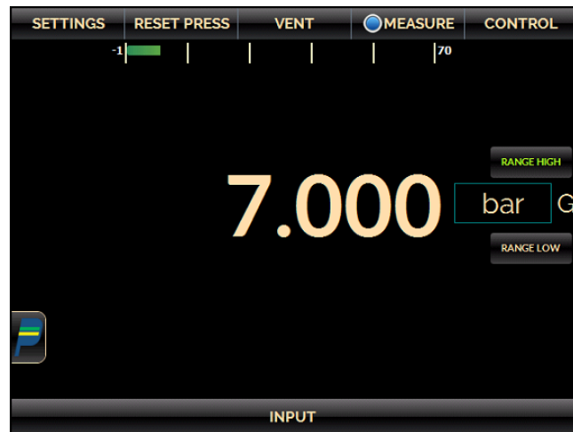
Fig. 09 – 測量操作方式之工作螢幕.
